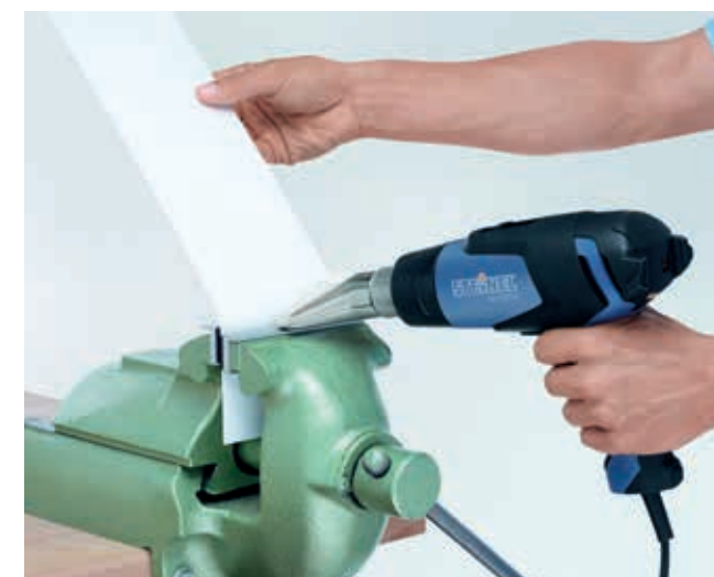
Forma. Forma plast exakt till önskad form med värme.
